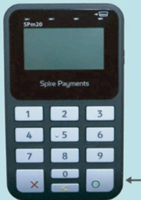
Acepte la conexión Bluetooth: Primero en el Pin Pad (pulsando la **TECLA VERDE**) y después en el smartphone, y ambos quedarán enlazados permanentemente. Cuando se muestre en la pantalla del pin pad el logotipo de Redsys o logo de su entidad, el dispositivo estará conectado.
