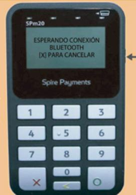
Encienda el dispositivo pulsando el botón de **ENCENDER (lateral derecho)**. Tras unos segundos se mostrará la pantalla inicial del dispositivo con las letras BT en la parte superior de la pantalla parpadeando. En este momento ya estará operativo y podrá sincronizarlo mediante **BLUETOOTH** con el smartphone.
