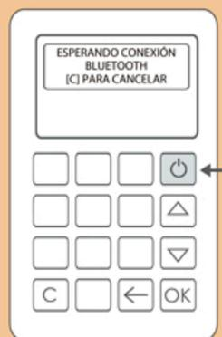
Encienda el dispositivo pulsando el botón de **ENCENDER**. Cuando se muestre en la pantalla el logo de su entidad, el dispositivo ya estará operativo y podrá sincronizarlo mediante **BLUETOOTH** con el Smartphone.
